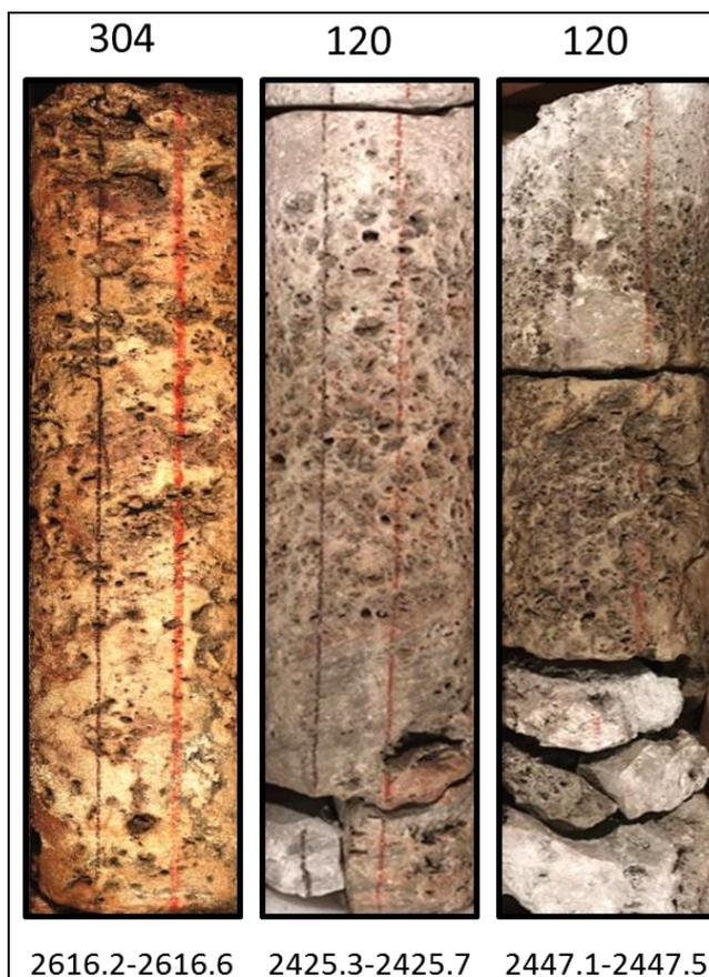
Рисунок 2.1 – Повышенная кавернозность в керне скважин 120 и 304
